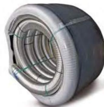
*De Flexibels van FLEXINOX bevatten een verhoogd molybdeengehalte. Dit resulteert in een betere bescherming tegen corrosieve condensaten. Iedere brandstof (gas, hout, pellet, mazout, kolen, ...) heeft een ander kenmerk van rookgas. Zo komt er bij de verbranding van gas veel condensaat in het rookkanaal, terwijl het verbranden van kolen dan weer veel zwavel produceert. Daarom biedt Flexinox voor bijna iedere brandstof een specifieke flexibel aan.*
