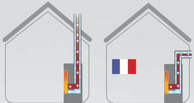
Exemple d'installation avec la sortie des fumées et la w d'air extérieure coaxiales.
