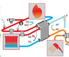
**\*Kit V** « à sac au dos » pour H2Oceano À VASE OUVERT doté d'écran déporté. Kit pour séparer l'installation primaire de celle secondaire avec thermo-cheminée associées à une chaudière à gaz avec production instantanée d'eau sanitaire; comprenant un circulateur pour le circuit secondaire. Composé de : échangeur à 3 voies, électrovanne à 3 voies, circulateurs, vanne de sécurité, fluxostat à effet Hall, carte électronique.
